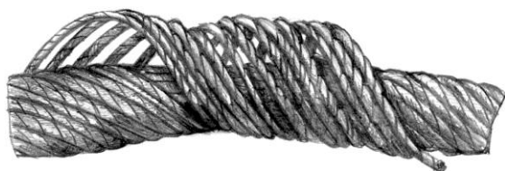
Корзинообразная деформация каната
