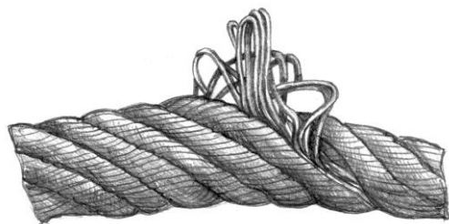
Корзинообразная деформация каната
