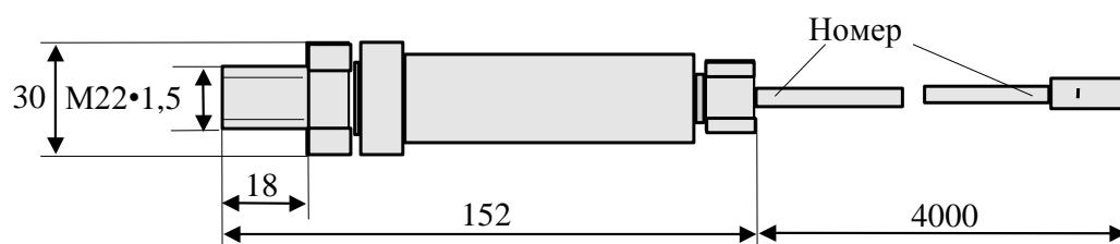
Рисунок 4 - Преобразователь давления
