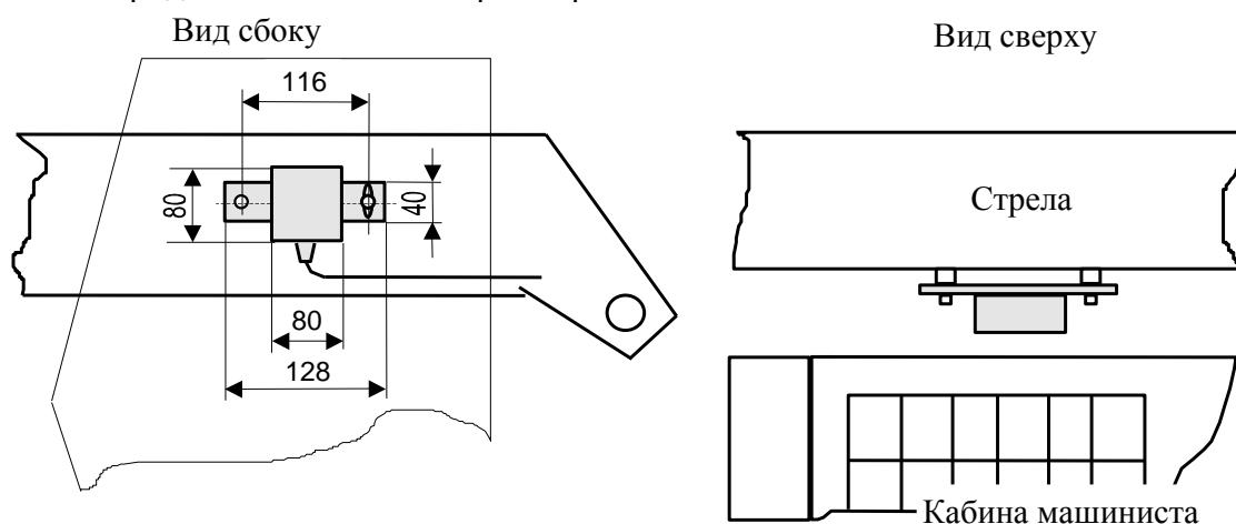
Рисунок 1 - Установка датчика угла маятникового
