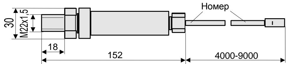
Рисунок 4 - Преобразователь давления
