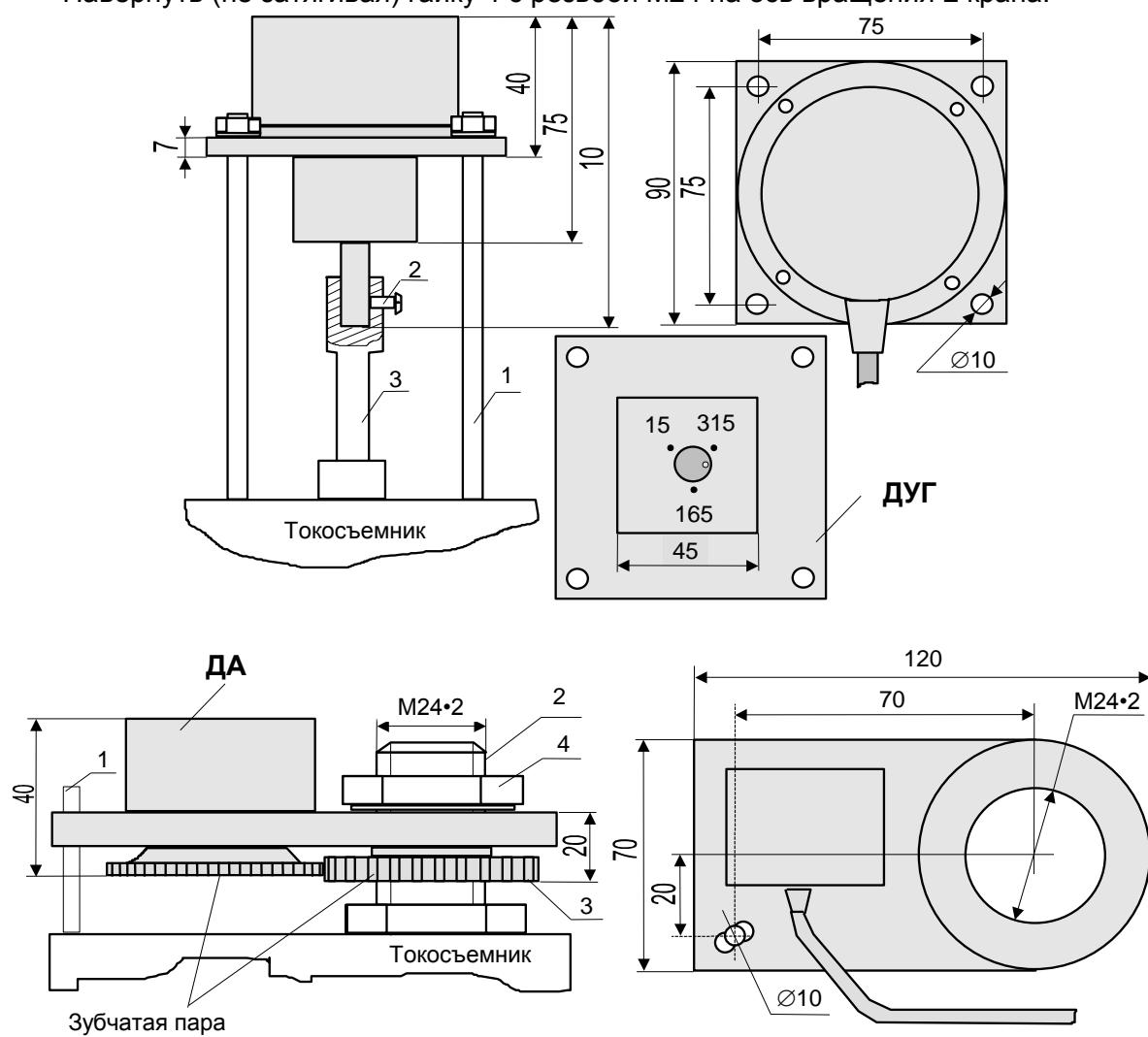
Рисунок 3 - Установка датчика угла
