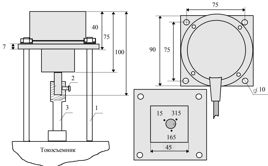
Рисунок 3 - Установка датчика угла
