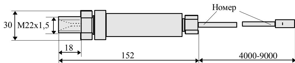
Рисунок 4 - Преобразователь давления
