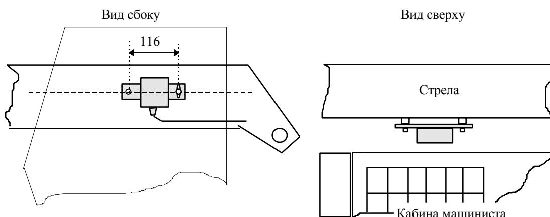
Рисунок 1 - Установка датчика угла маятникового
