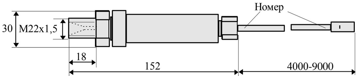
Рисунок 4 - Преобразователь давления
