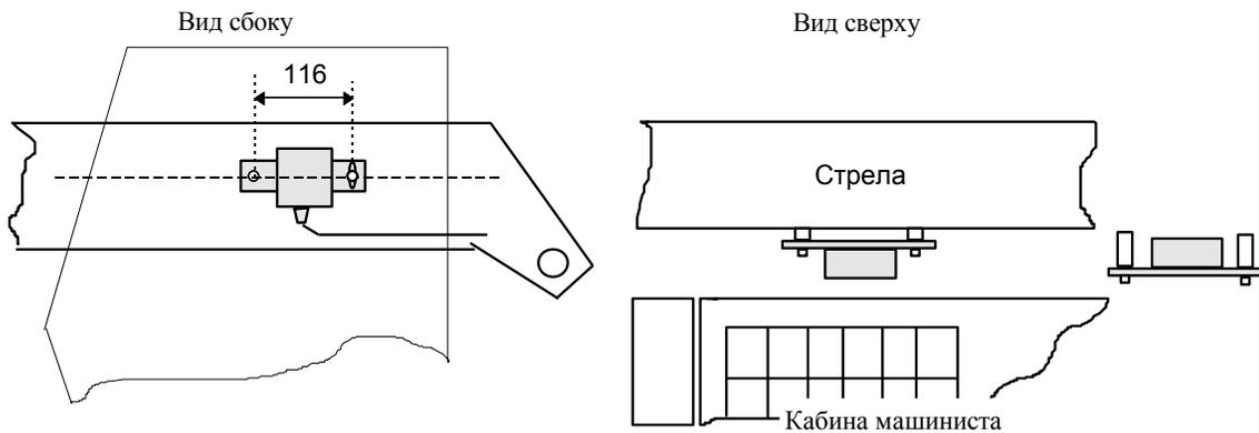
Рисунок 1 - Установка датчика угла маятникового
