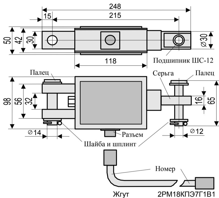
Рисунок 5 - Преобразователь усилия
