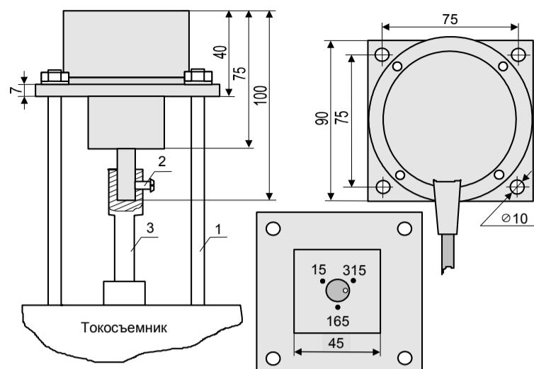
Рисунок 4 - Установка датчика угла
