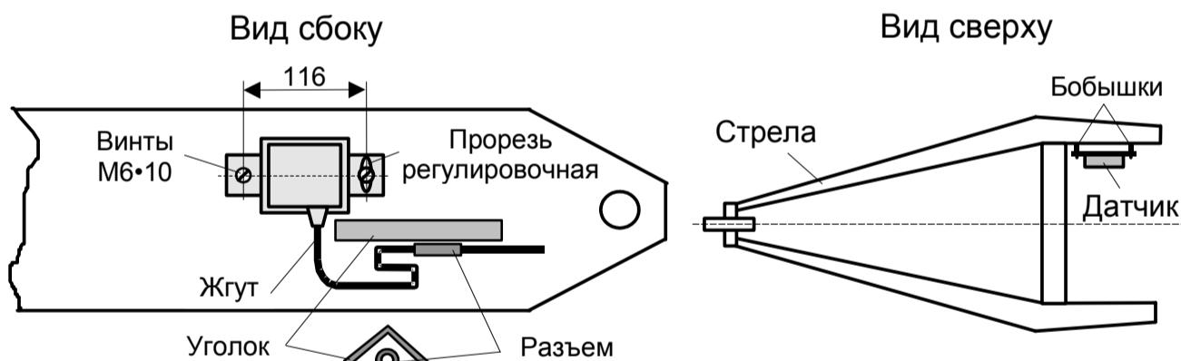
Рисунок 1 - Установка датчика угла маятникового
