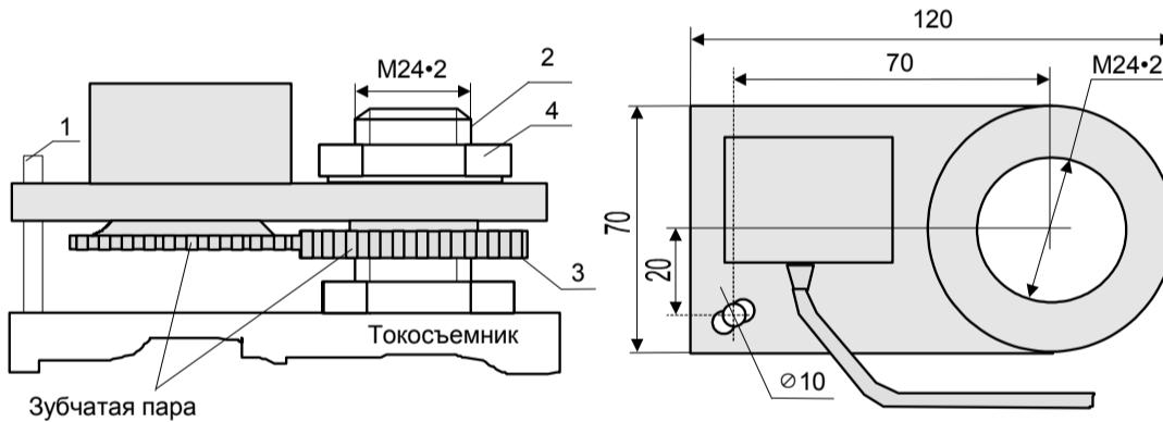
Рисунок 3 - Установка датчика азимута
