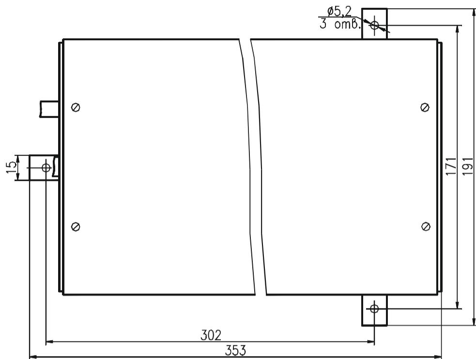
Рисунок 6 - Габаритные и присоединительные размеры БОД и БПВР
