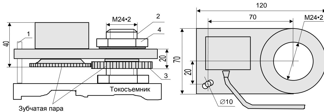
Рисунок 2 - Установка датчика угла поворота платформы (азимута)
