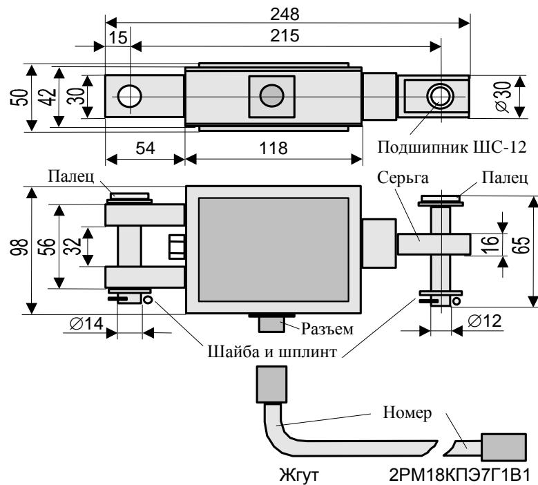
Рисунок 3 - Преобразователь усилия
