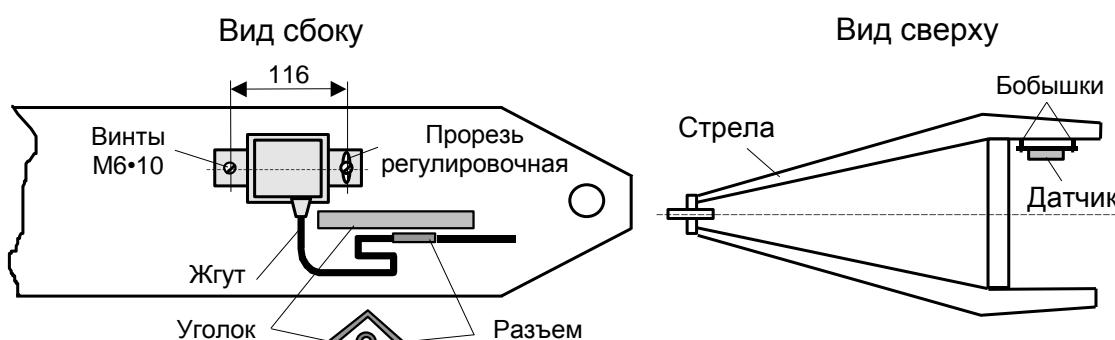
Рисунок 1 - Установка датчика угла маятникового
