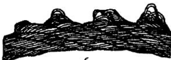
Рисунок 12. Выдавливание проволок прядей:
