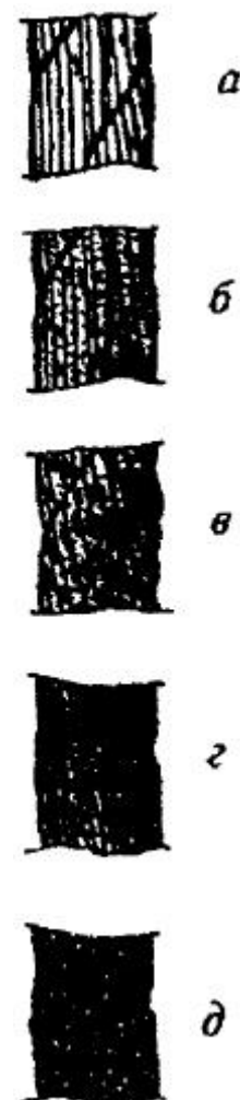
Рисунок 6. Поверхностная коррозия проволок каната крестовой свивки:
