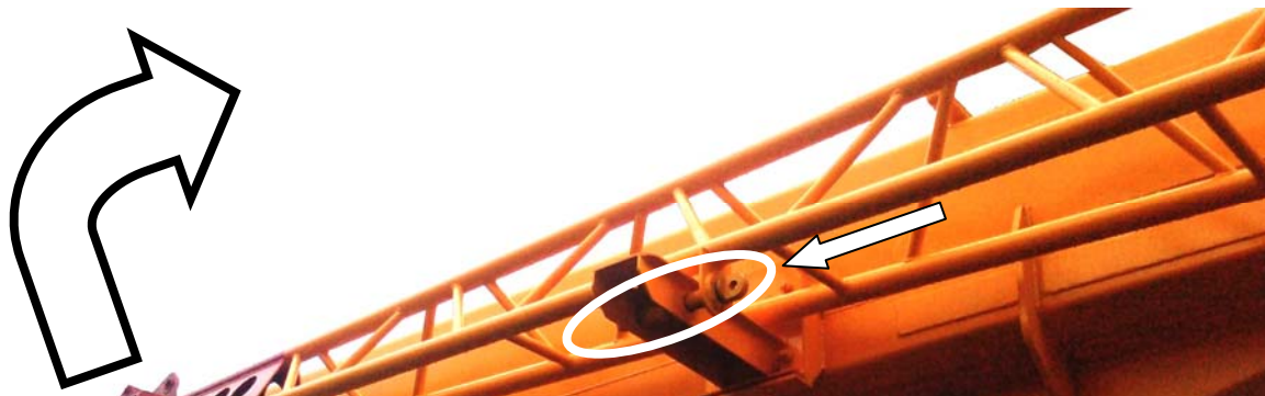
Рисунок 13.41 – Установка пальца в кронштейн на стреле
