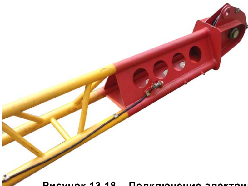
Рисунок 13.18 – Подключение электрического кабеля на гуське
