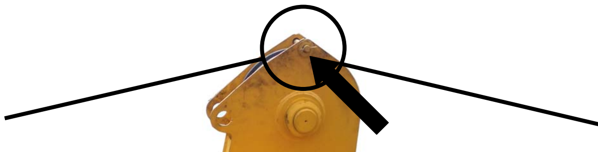
Рисунок 13.31 – Установка оси на блоке основания гуська
