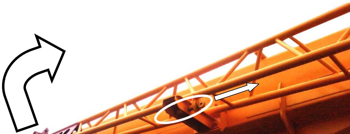
Рисунок 13.8 – Удаление пальца из кронштейна на стреле
