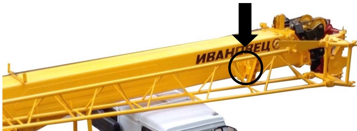
Рисунок 13.37 – Установка пальца в кронштейн на оголовке стрелы
