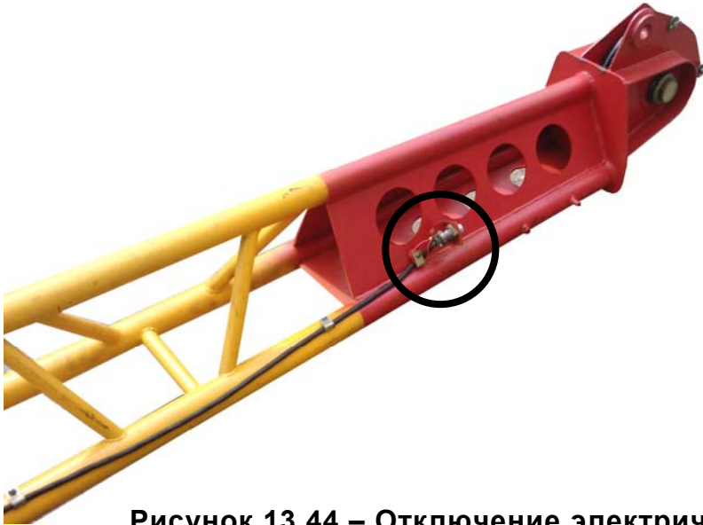
Рисунок 13.44 – Отключение электрического кабеля на гуське
