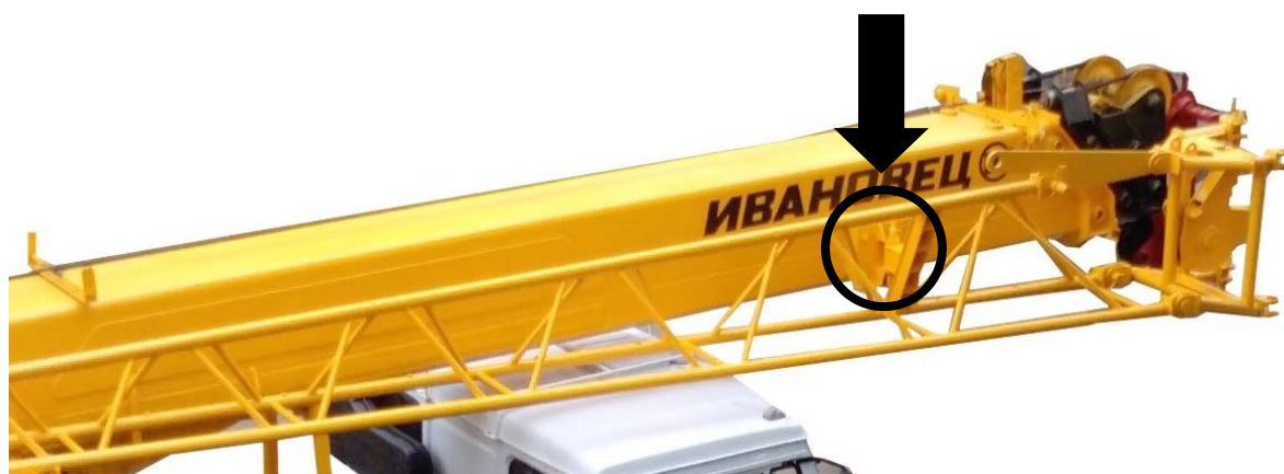
Рисунок 13.37 – Установка пальца в кронштейн на оголовке стрелы
