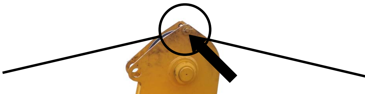
Рисунок 13.25 – Установка оси на блоке основания гуська
