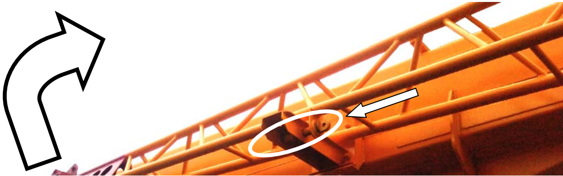
Рисунок 13.41 – Установка пальца в кронштейн на стреле
