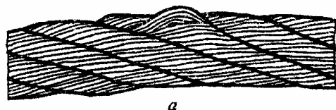
Рисунок Н.3 - Выдавливание сердечника
