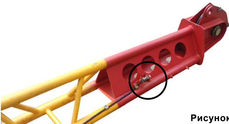
Рисунок 13.16 – Установка осей с фиксаторами на оголовке гуська
