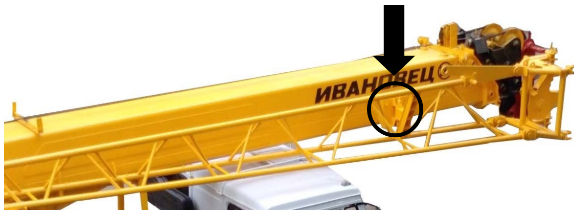
Рисунок 13.37 – Установка пальца в кронштейн на оголовке стрелы
