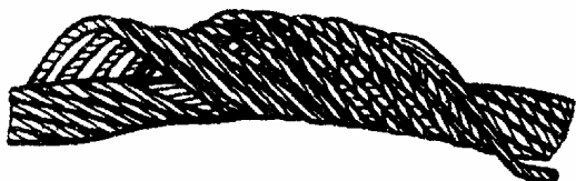
Рисунок Н.2 - Корзинообразная деформация
