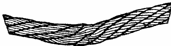
Рисунок Н.9 - Залом каната
