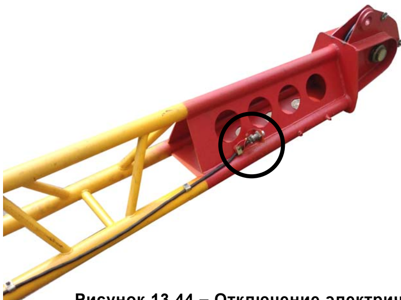
Рисунок 13.44 – Отключение электрического кабеля на гуське
