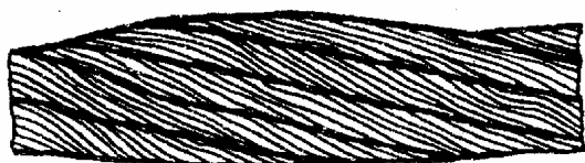
Рисунок Н.5 – Местное увеличение диаметра каната
