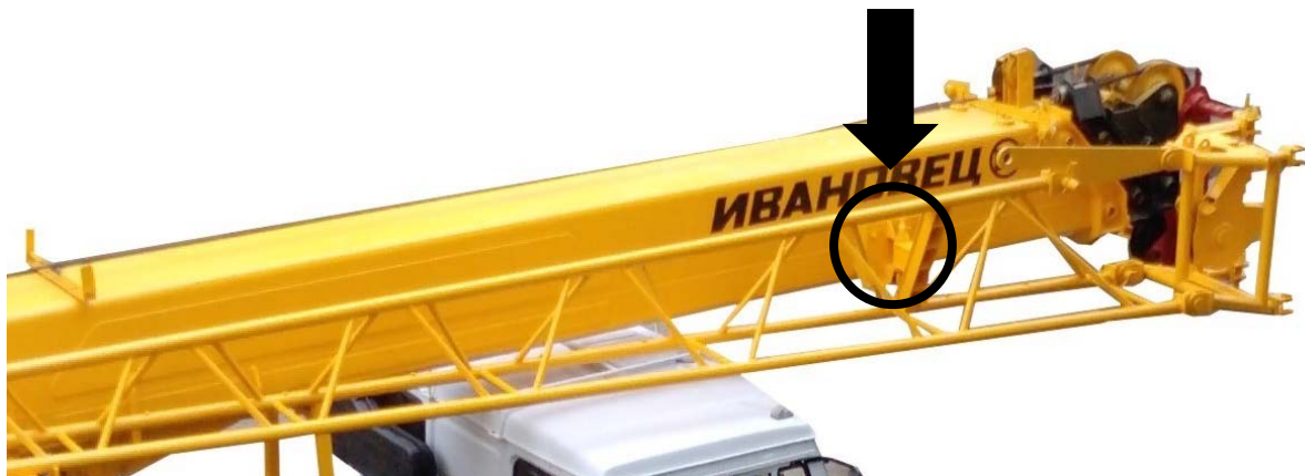
Рисунок 13.37 – Установка пальца в кронштейн на оголовке стрелы
