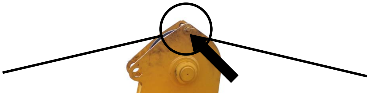
Рисунок 13.15 – Установка оси на блоке основания гуська
