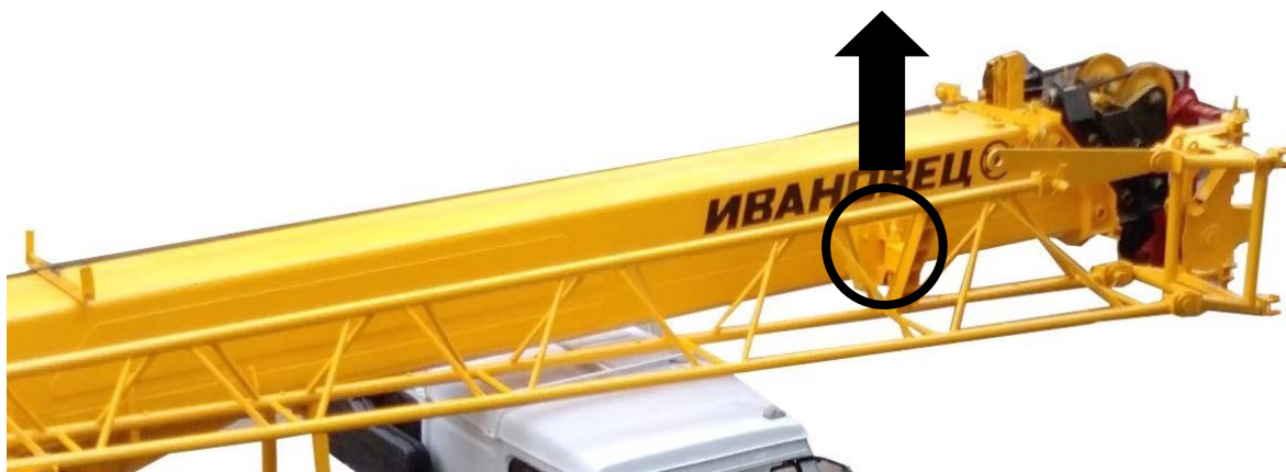
Рисунок 13.11 – Удаление пальца из кронштейна на оголовке стрелы
