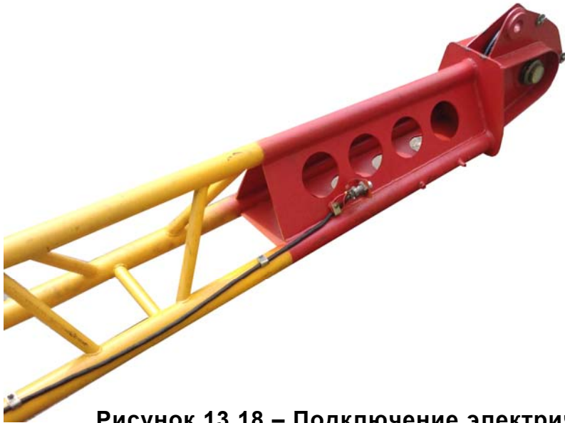
Рисунок 13.18 – Подключение электрического кабеля на гуське
