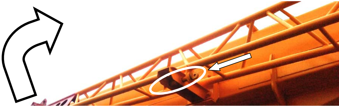
Рисунок 13.41 – Установка пальца в кронштейн на стреле
