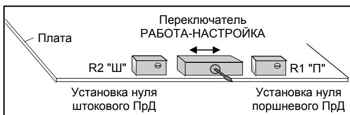
Рисунок 7 – Размещение регулировочных резисторов на плате БОДа
