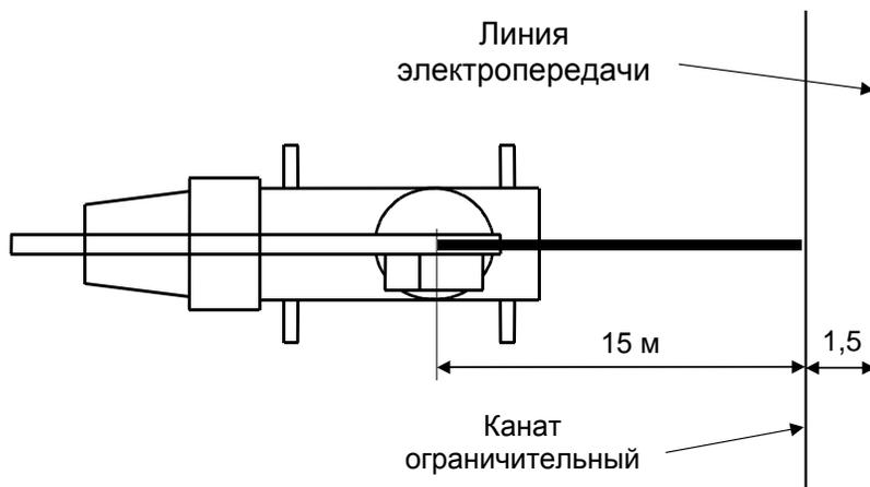
Рисунок 6 - Проверка срабатывания МЗОНа
