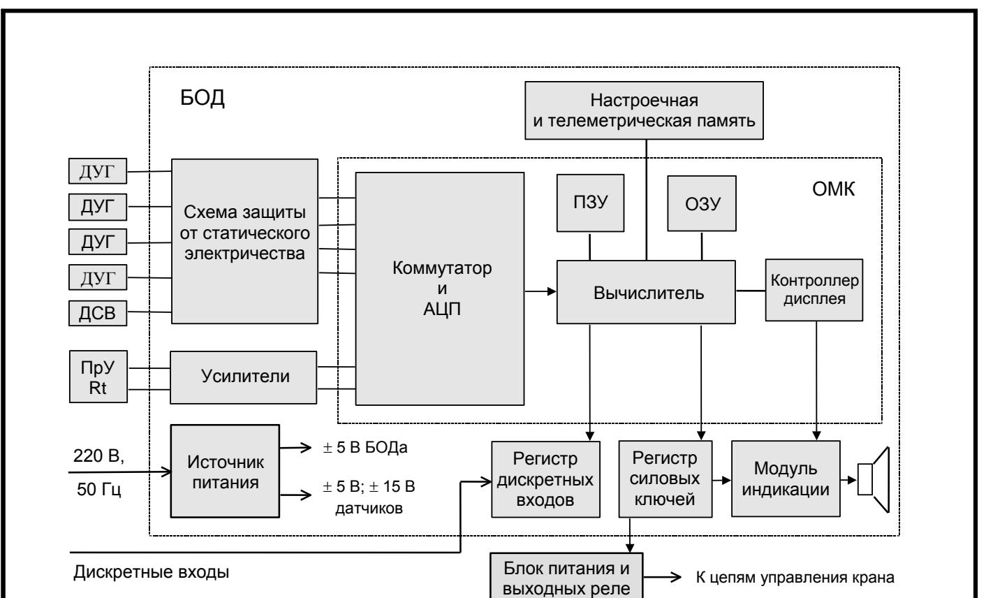
Рисунок 1 - Блок-схема ограничителя
