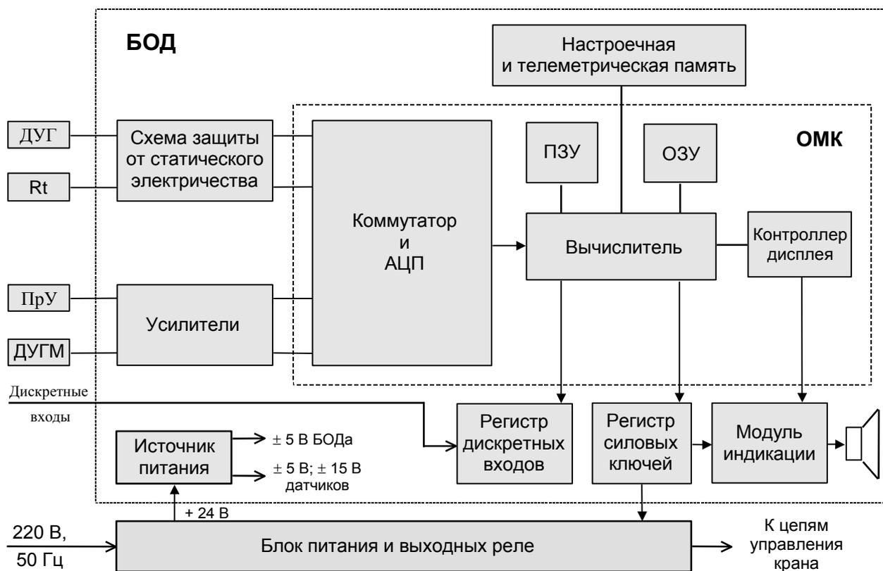
Рисунок 1 - Блок-схема ограничителя
