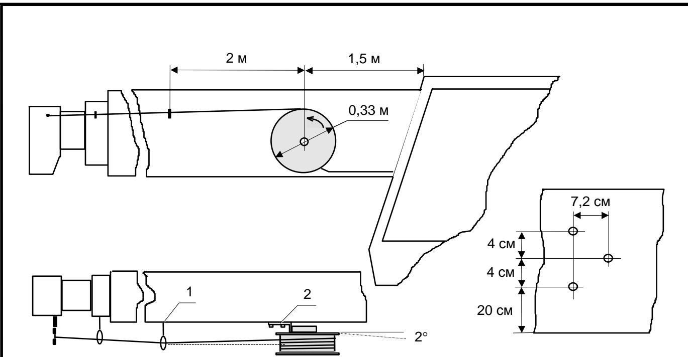
Рисунок 9 - Установка датчика длины стрелы и разметка мест крепления
