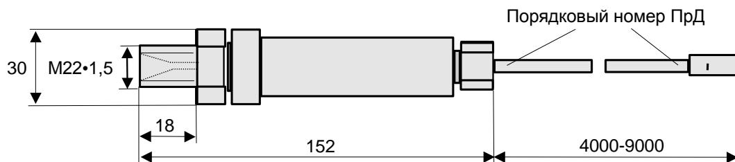
Рисунок 8 - Преобразователь давления
