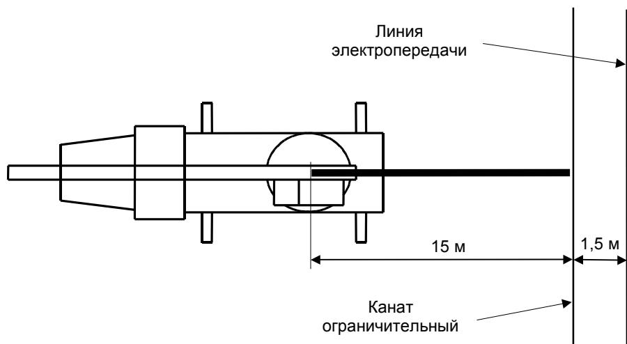
Рисунок 22 - Проверка срабатывания МЗОНа
