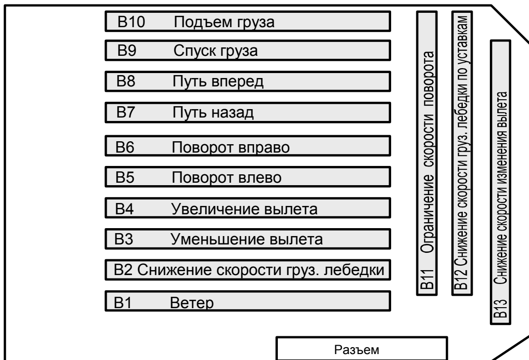
Рисунок 25 - Расположение плат электронных реле в БРС
