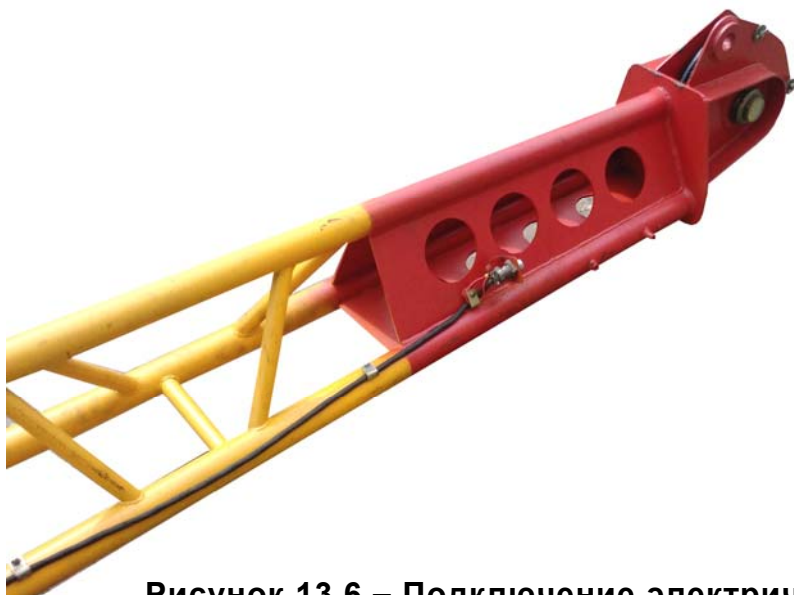
Рисунок 13.6 – Подключение электрического кабеля на гуське
