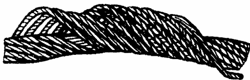
Рисунок Н.2 - Корзинообразная деформация
