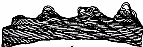
Рисунок Н.4 - Выдавливание проволок прядей
