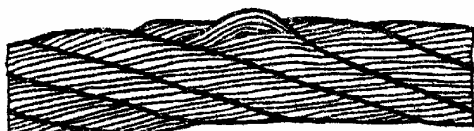
Рисунок Н.3 - Выдавливание сердечника
