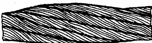
Рисунок Н.5 – Местное увеличение диаметра каната
