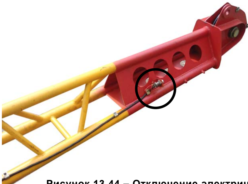
Рисунок 13.44 – Отключение электрического кабеля на гуське
