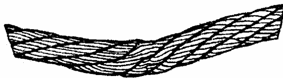
Рисунок Н.9 - Залом каната
