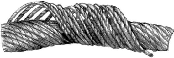
Корзинообразная деформация каната
