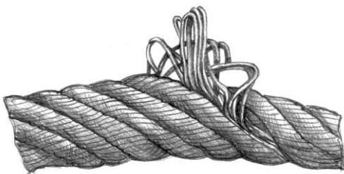
Корзинообразная деформация каната
