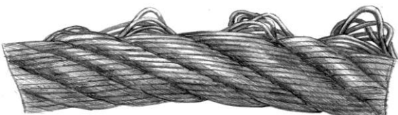
Выдавливание проволок прядей (одной)
