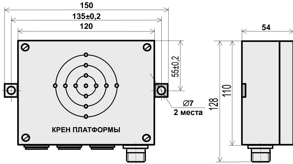
Рисунок 15 - Габаритные и присоединительные размеры ИК
