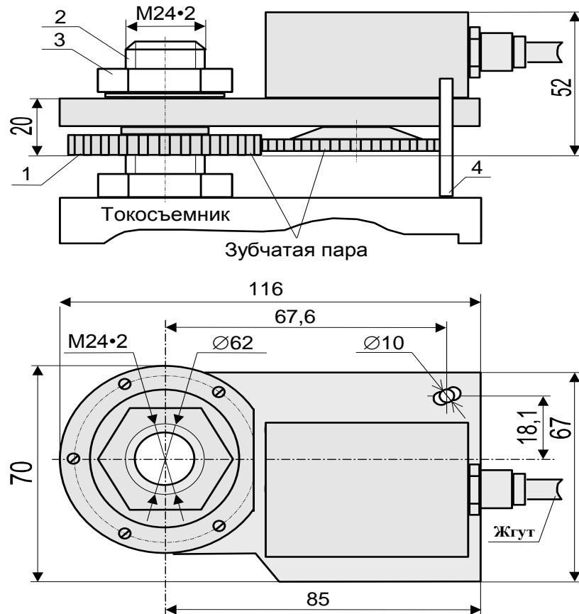
Рисунок 12 - Установка датчика азимута
