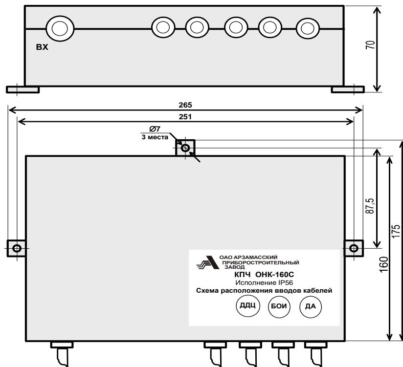
Рисунок 13 - Габаритные и присоединительные размеры КПЧ и КНЧ
