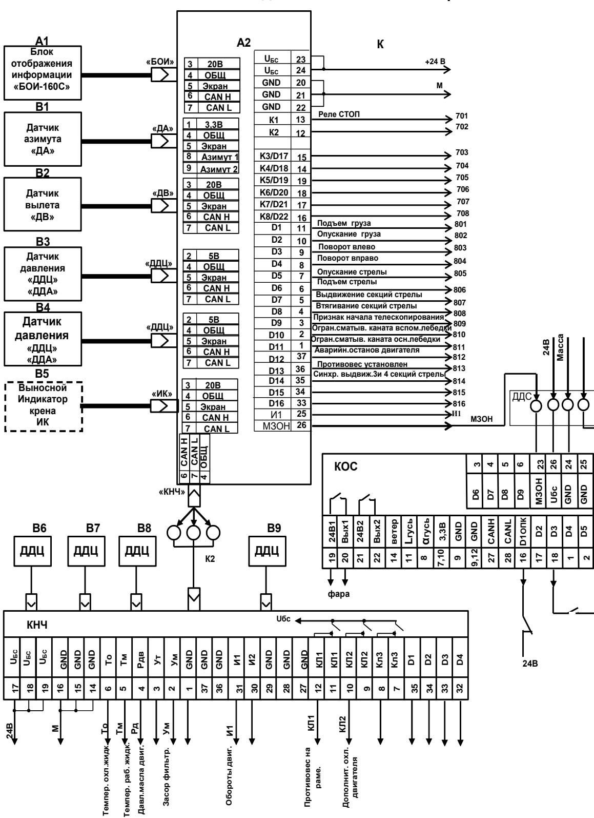
Рисунок Б.1 Схема подключения ОНК на кране КС- КС-65713
