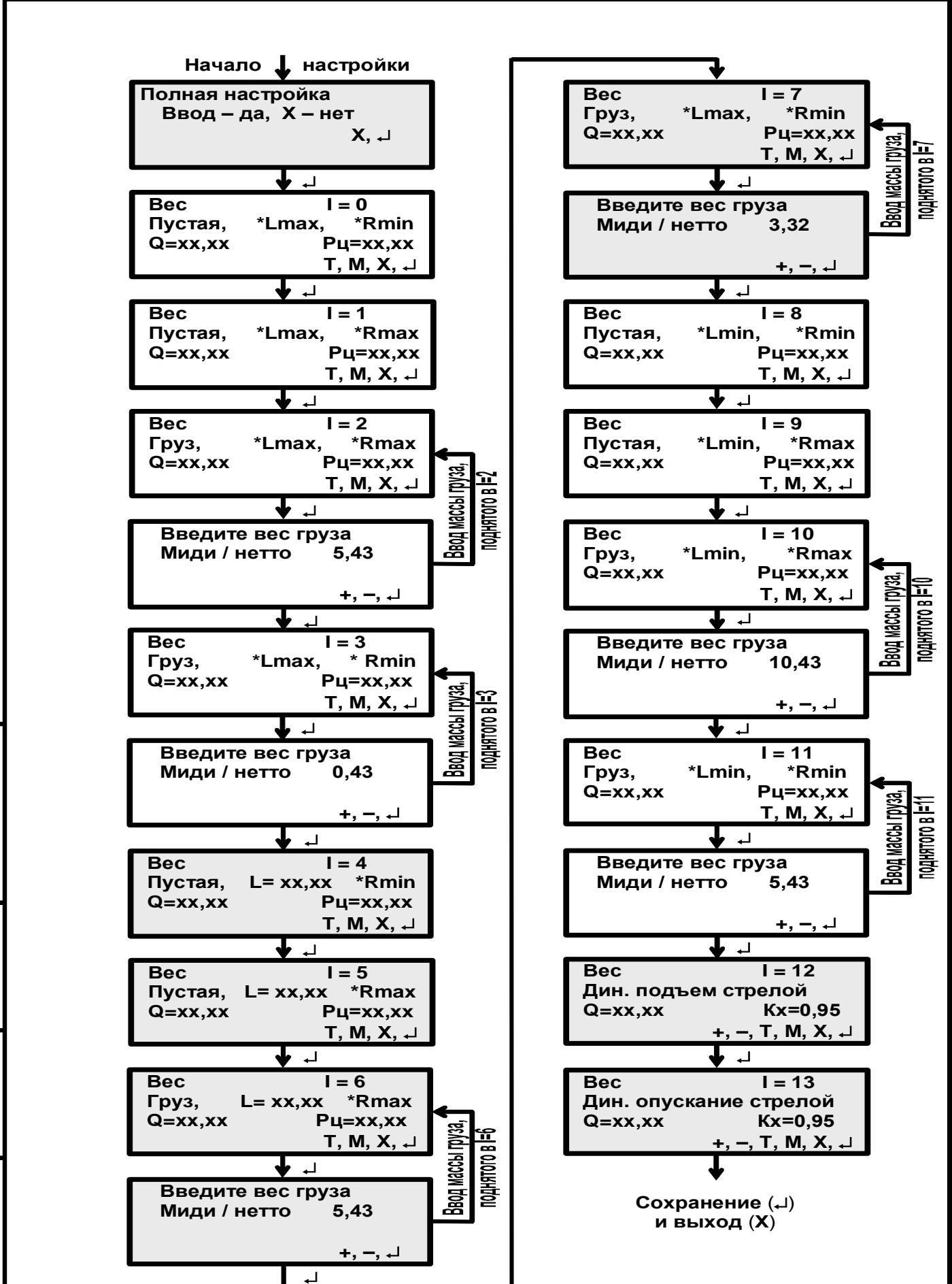
При полной настройке после каждого нажатия на кнопку ВВОД производится перерасчет параметров для всех длин стрел.
