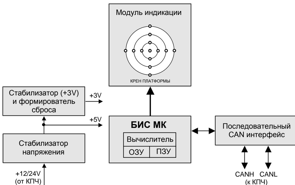
Рисунок 8 - Блок-схема ИК
