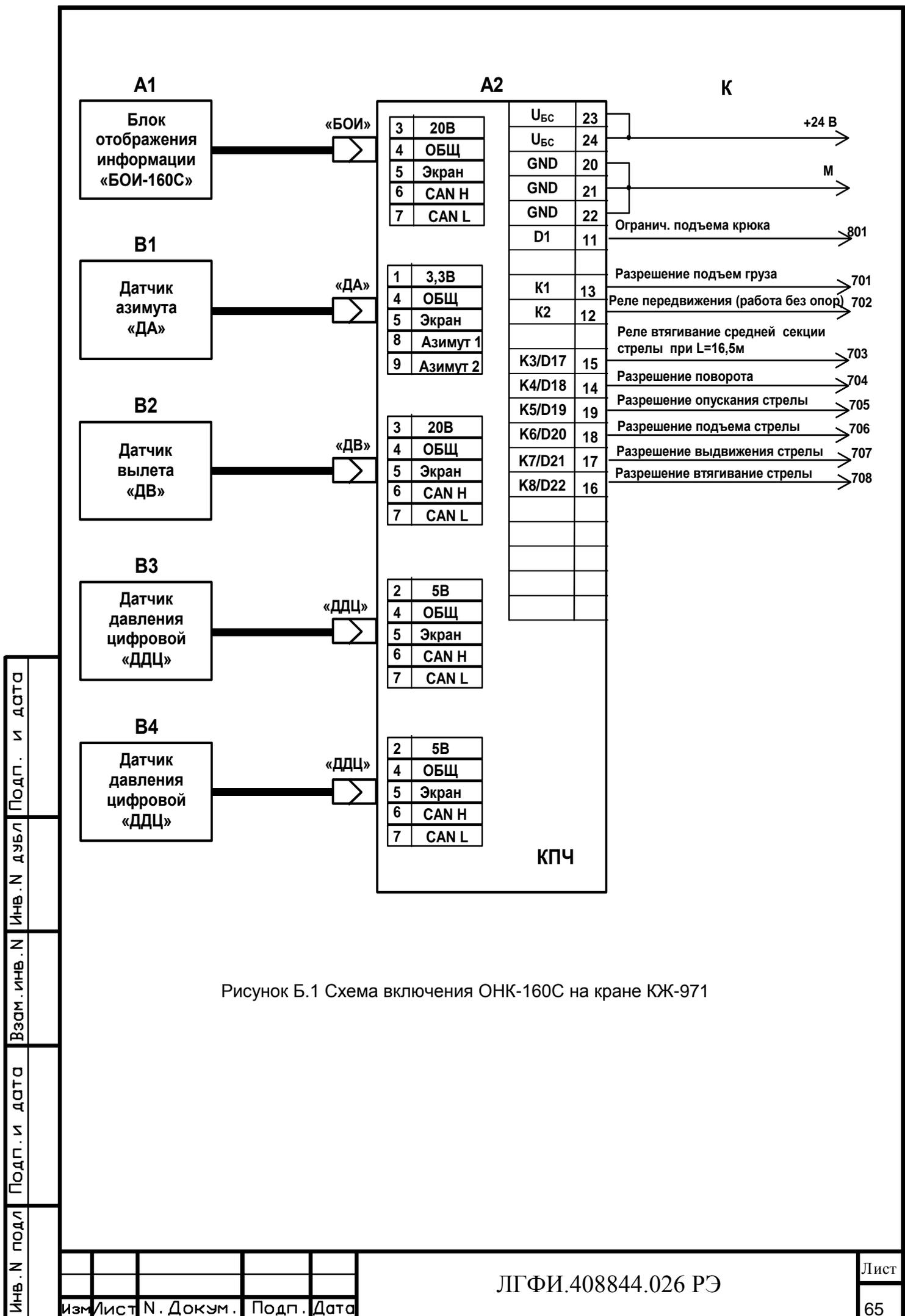
Рисунок Б.1 Схема включения ОНК-160С на кране КЖ-971
