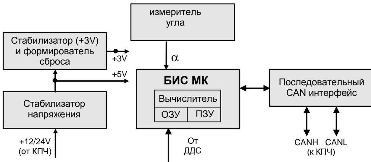
Рисунок 7 - Блок-схема ДНС
