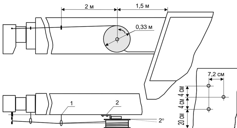
Рисунок 11 - Установка ДДС и разметка мест крепления
