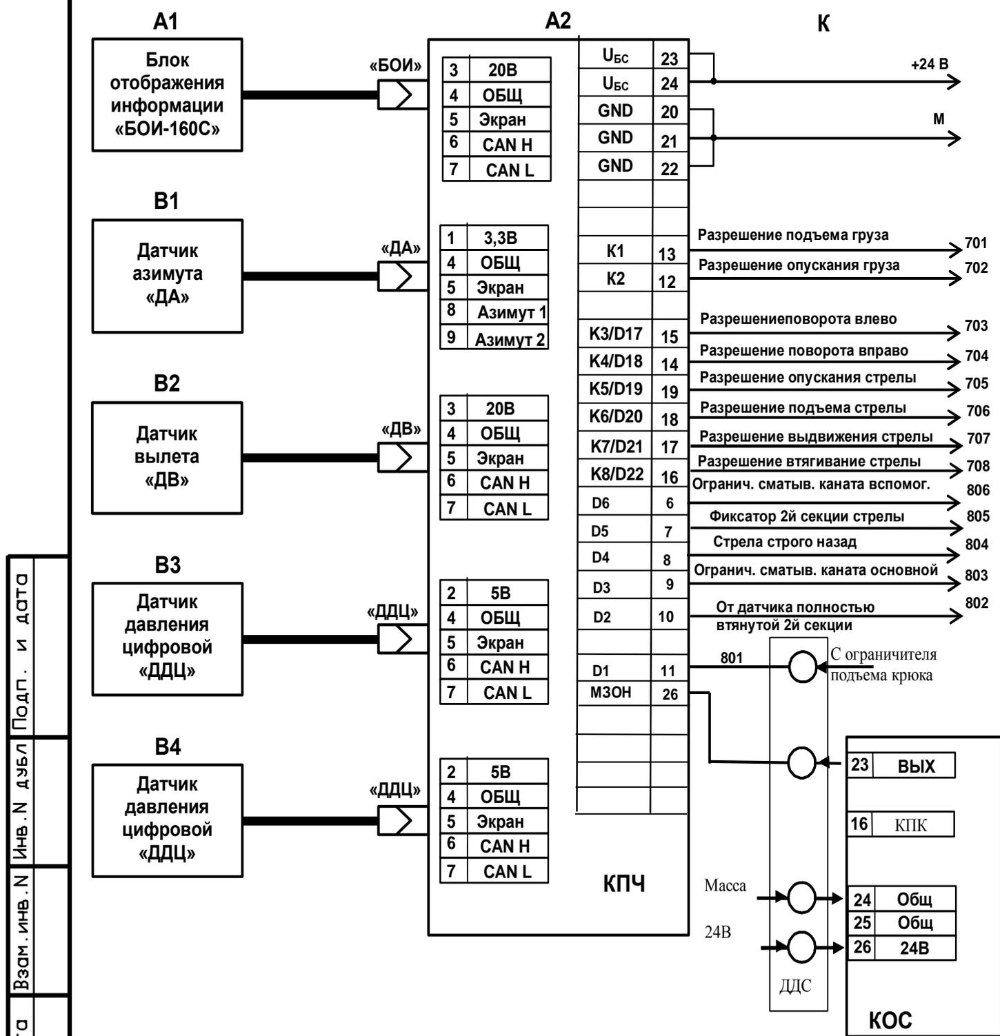
Рисунок Б.2 Схема включения ОНК-160С-13 на кране КС-8973
