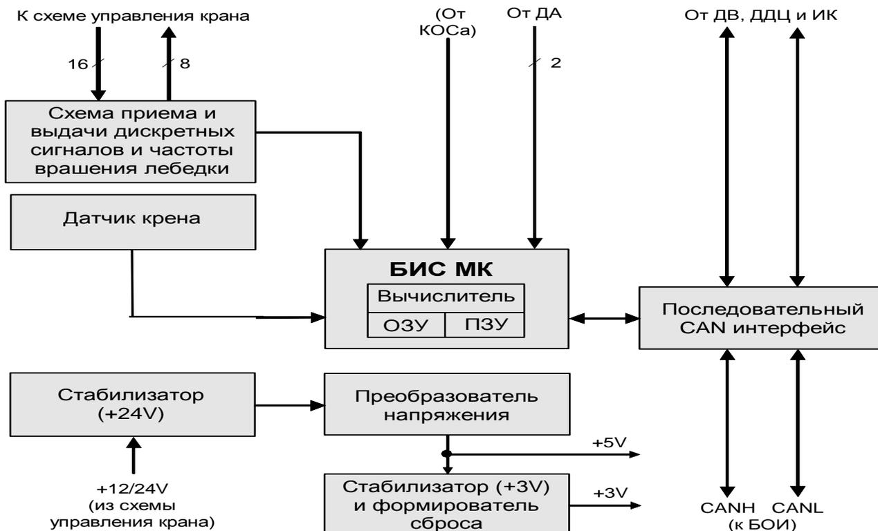
Рисунок 4 - Блок-схема КПЧ
