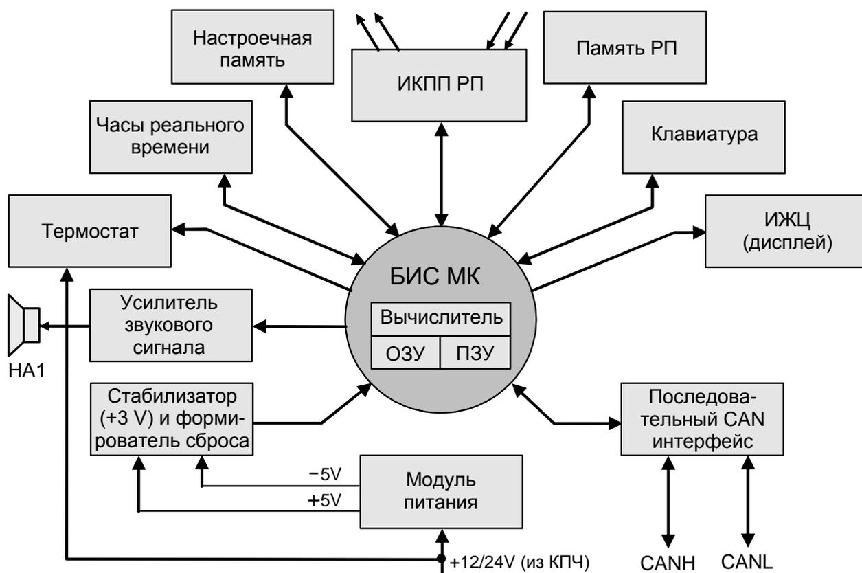
Рисунок 2 - Блок-схема БОИ
