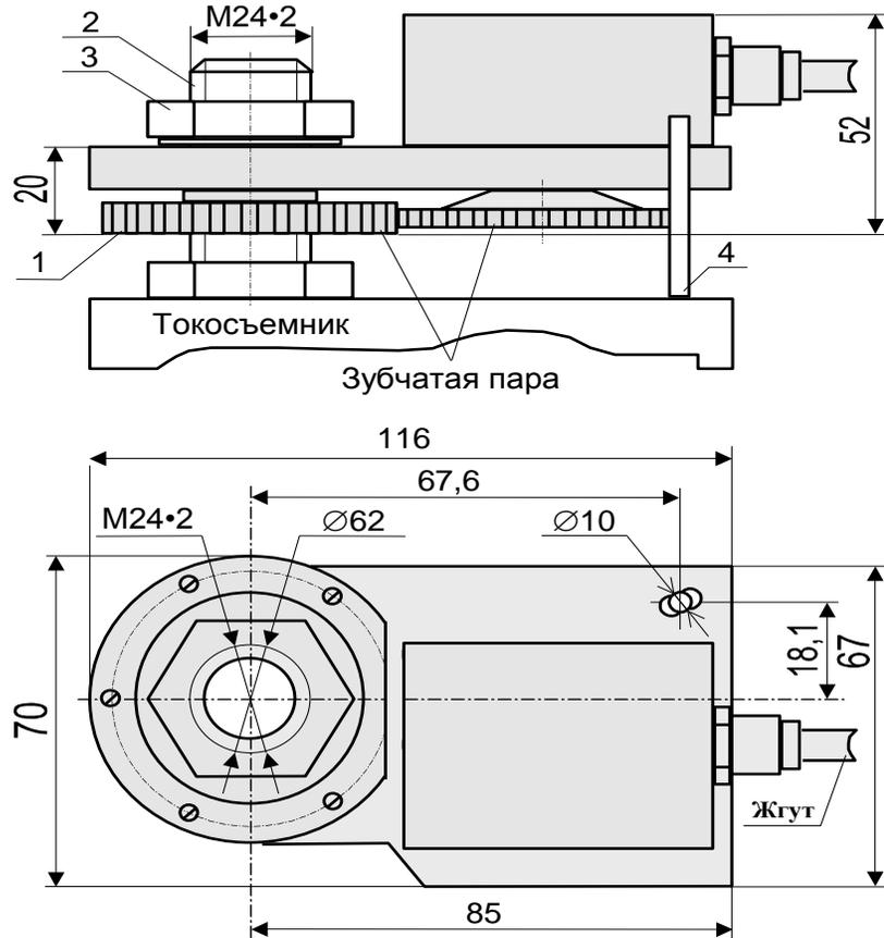
Рисунок 12 - Установка датчика азимута
