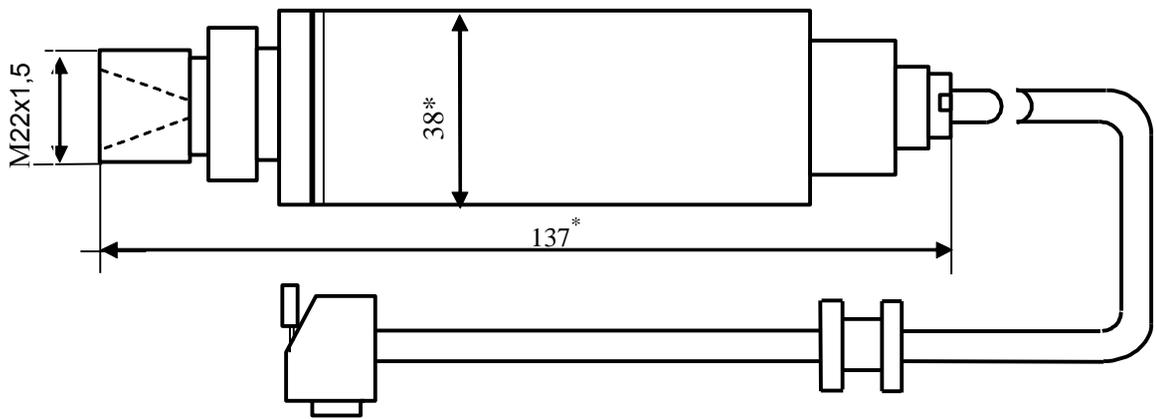
Рисунок 10 - Габаритные и присоединительные размеры ДДЦ
